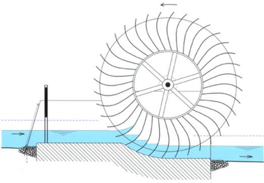
Abb. 3: Zuppinger – Wasserrad (3)
