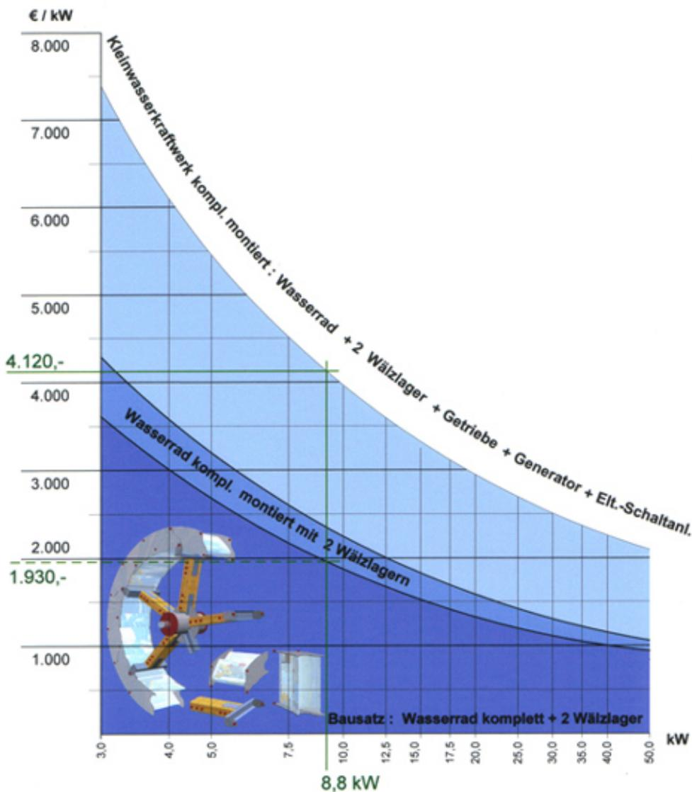
Abb. 7: Kosten Wasserrad (Quelle : www.wasserrad-drehs.de)
