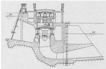
Abb. 10: Kaplan – Betonspiralturbine <sup>7)</sup>
